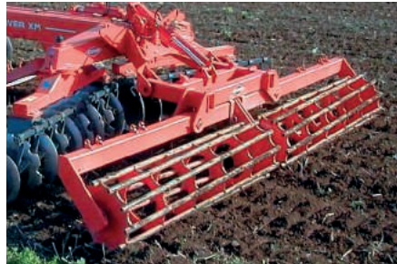
CRUMBLER ROLLER Ø 550 - 75 KG/M
